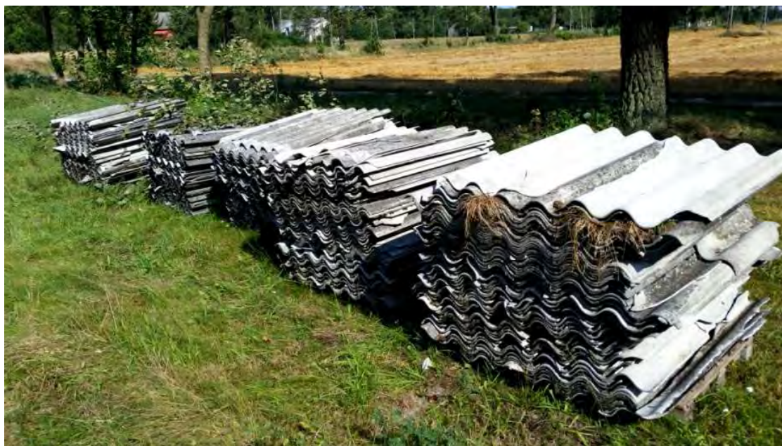
Rysunek 2. Złożone płyty azbestowe - faliste (źródło: materiały własne)
